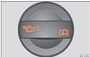
Fig. 318 Tapón de la boca de llenado de aceite del motor en el vano motor.
