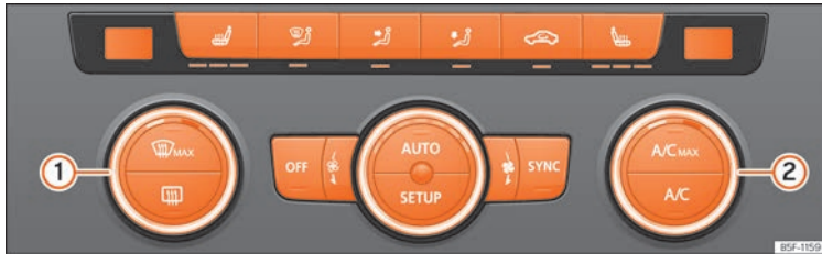
Fig. 170 En la consola central: mandos del Climatronic.
