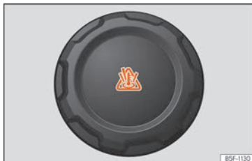
Fig. 320 Vano motor: tapón del depósito de expansión del líquido refrigerante.
