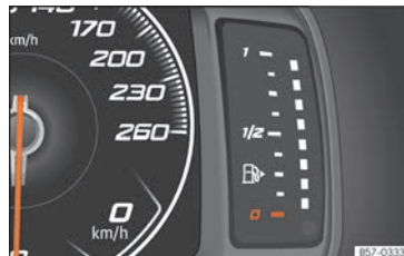
Fig. 80 Cuadro de instrumentos digital: indicador del nivel de combustible.
