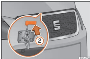
Fig. 315 Leva bajo el capó.
