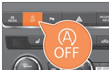
Fig. 257 Consola central: tecla del sistema Start-Stop.
