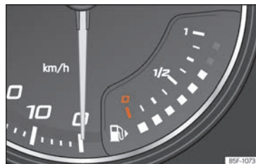
Fig. 79 Cuadro de instrumentos analógico: indicador de nivel de combustible
