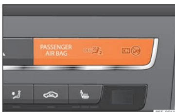
Fig. 18 Tablero de instrumentos: testigo de control de la desactivación del airbag del acompañante.
