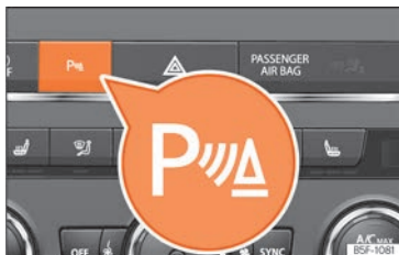
Fig. 291 Consola central: tecla de la ayuda de aparcamiento.
