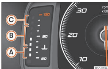
Fig. 83 Cuadro de instrumentos digital: indicador de temperatura del líquido refrigerante del motor.
