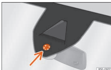
Fig. 122 Superficie sensible del sensor de lluvia.
