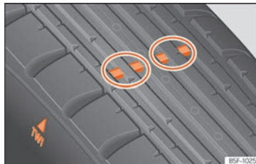
Fig. 324 Perfil del neumático: indicadores de desgaste.
