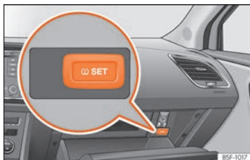
Fig. 327 Guantero: interruptor para el control de los neumáticos.
