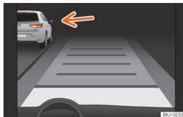
Fig. 278 En la pantalla del cuadro de instrumentos: ACC activo, vehículo detectado por la izquierda
