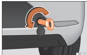
Fig. 50 Parte derecha del parachoques trasero: argolla de remolque enroscada.
