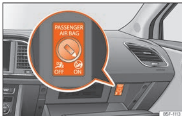
Fig. 17 Conmutador del airbag frontal del acompañante.
