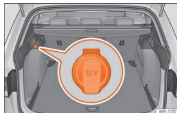
Fig. 168 Detalle del revestimiento lateral del maletero: toma de corriente de 12 voltios (válido sólo para el modelo Leon Sportourer ST).
