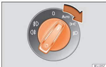
Fig. 114 Tablero de instrumentos: mando de las luces.
