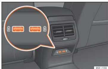
Fig. 251 Parte posterior consola central: conectores USB.
