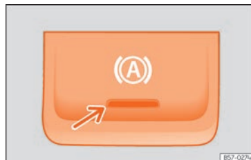
Fig. 287 En la parte inferior de la consola central: tecla de la función Auto Hold.
