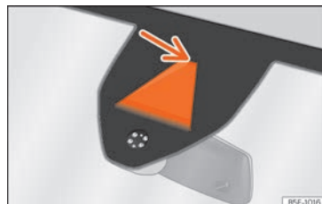
Fig. 281 En el parabrisas: área de campo visual del sistema de aviso de salida del carril.
