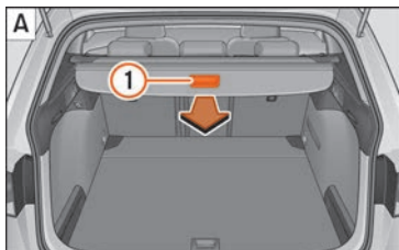
Fig. 140 En el maletero: desmontar la bandeja.
