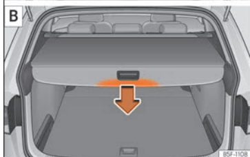
Fig. 139 En el maletero: desenrollar y enrollar la bandeja.
