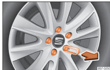
Fig. 36 Rueda: tornillos de la rueda con capuchones.
