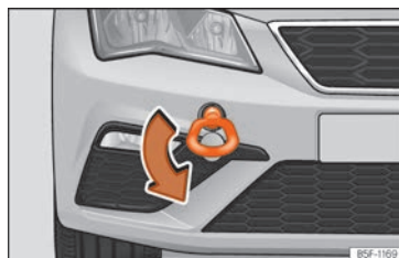
Fig. 48 Parte derecha del parachoques delantero: argolla de remolque enroscada.
