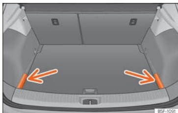
Fig. 141 En el maletero: tapas para guardar la bandeja.
