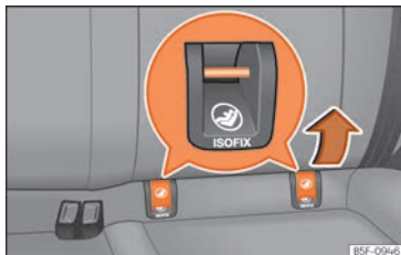
Fig. 28 Asiento trasero: anillas de sujeción ISOFIX.
