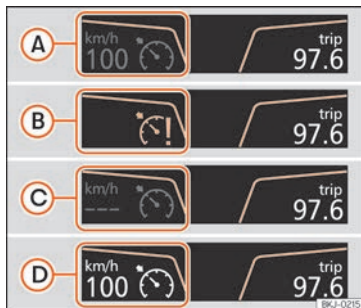
Fig. 267 Pantalla del cuadro de instrumentos: indicaciones de estado del GRA.
