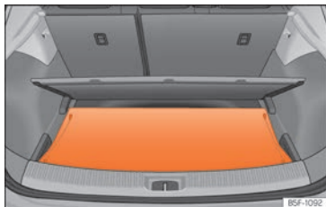
Fig. 142 En el maletero: colocación de la bandeja.
