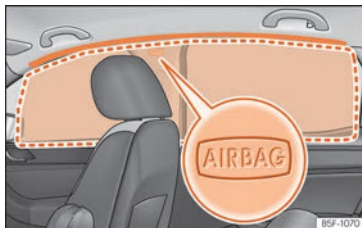
Fig. 23 Ubicación de los airbags para la cabeza.
