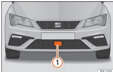
Fig. 270 En el paragolpes delantero: sensor de radar.
