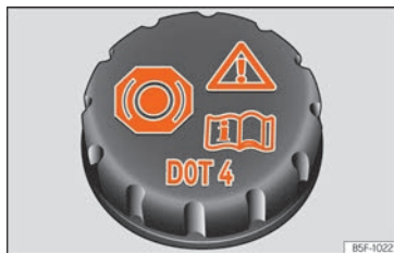
Fig. 321 Vano motor: tapón del depósito del líquido de frenos.
