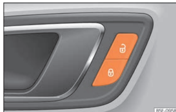
Fig. 97 Puerta del conductor: conmutador del cierre centralizado.
