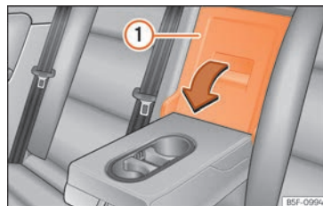
Fig. 155 En el respaldo del asiento trasero: apertura de la trampilla.
