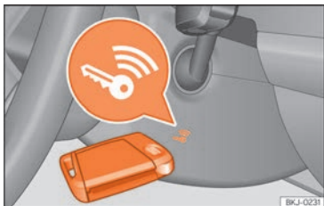
Fig. 256 A la derecha de la columna de dirección: arranque de emergencia.
