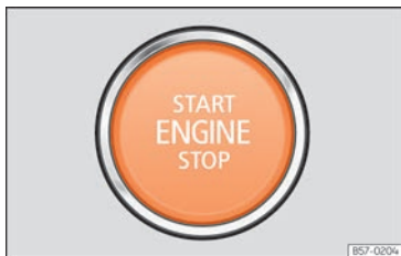
Fig. 255 En la parte inferior de la consola central: pulsador de arranque.
