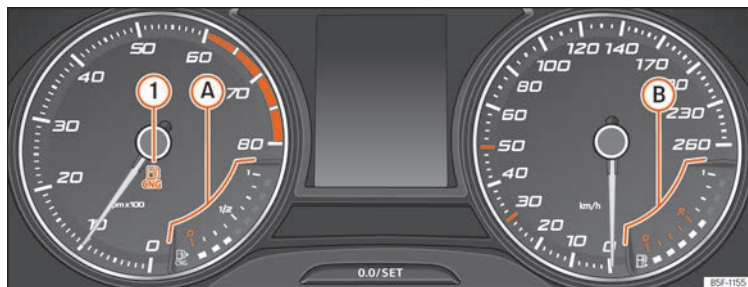
Fig. 81 Cuadro de instrumentos analógico: indicador de nivel de gas natural
