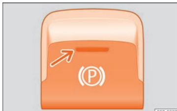
Fig. 285 En la parte inferior de la consola central: tecla del freno de estacionamiento electrónico.
