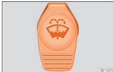
Fig. 322 En el vano motor: tapón del depósito del limpiacristales.
