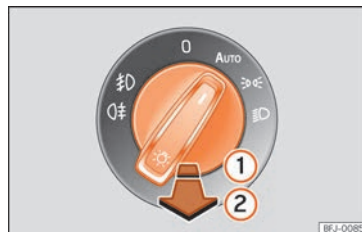
Fig. 115 Tablero de instrumentos: mando de las luces.
